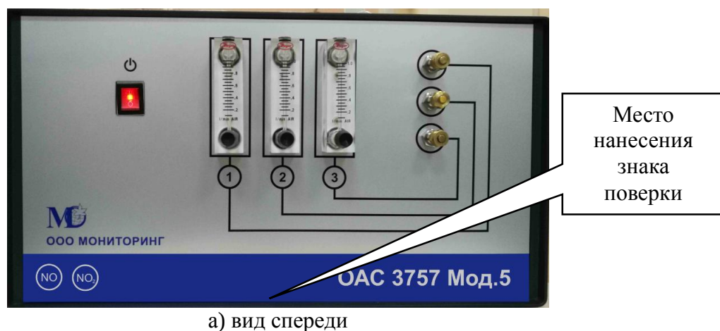
Рисунок 4 - Общий вид передней панели газоанализатора ОАС 3757, модификации Мод.4 и схема пломбирования корпуса газоанализатора от несанкционированного доступа
