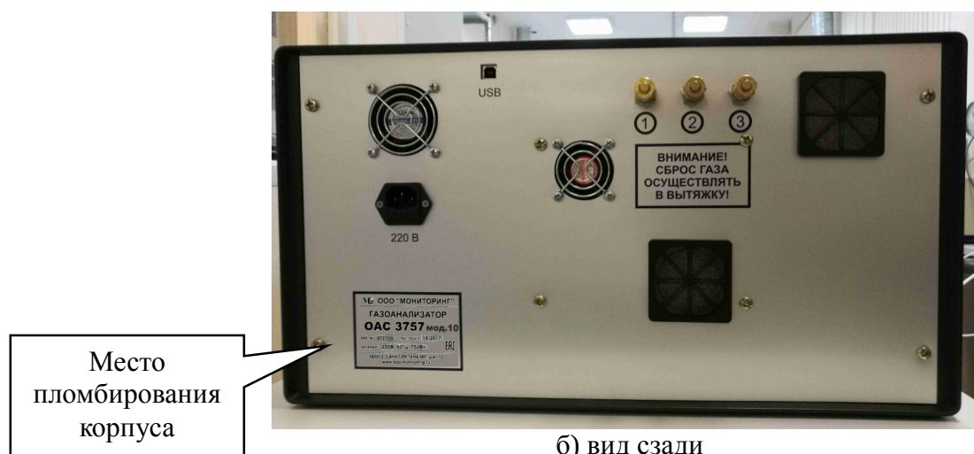
Рисунок 10 - Общий вид передней панели газоанализатора ОАС 3757, модификации Мод.10 и схема пломбирования корпуса газоанализатора от несанкционированного доступа
