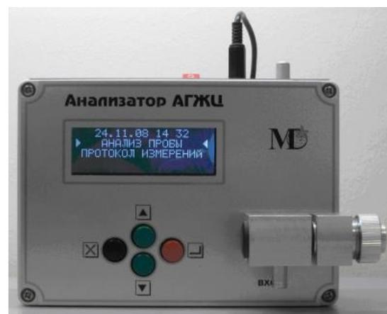
фотоспротивлением, находящимся в фотоячейке. Изменение окраски преобразователя ИЛ приводит к изменению светового потока и, соответственно, к изменению тока, протекающего через фотоспротивление ячейки анализатора
